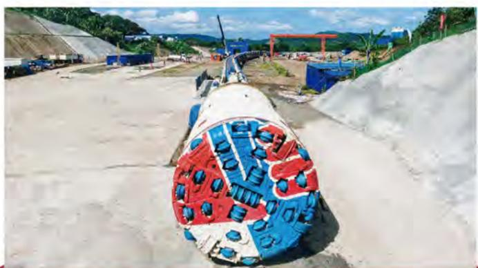
铁建重工双护盾TBM“茉莉号”
